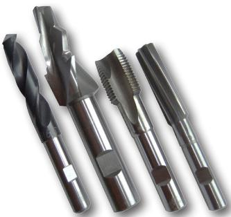
Významným prvkem pro správnou funkci vestavných ventilů jsou komory pro jejich montáž do bloku. Jejich funkce závisí jak na dodržení rozměrů, tak správné geometrii komor. Tyto požadavky lze technologicky splnit jen při použití speciálních sdružených nástrojů, vyráběných na zakázku z rychlořezné oceli. Přehled nástrojů pro obrábění komor najdete v katalogu SMT 0019.
